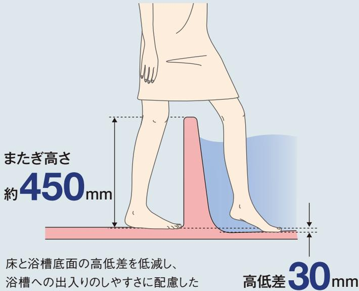
床と浴槽底面の高低差を低減し、
