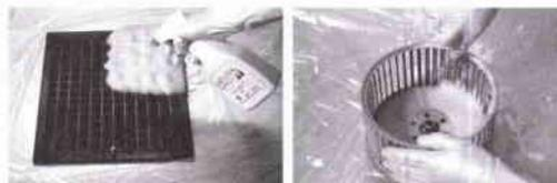
スロットフィルタやシロッコファンなど、凹凸がある部分に直接吹きかけ、20~30分置いたのち、歯ブラシ等で油汚れをかき出します。その後、水またはぬるま湯で洗い流してください。
