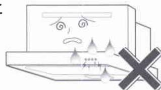
あまり汚れないうちに掃除してください。期間が長くなると、油が固まって汚れが落ちにくくなります。特にスロットフィルター・整流板は月に1回程度お掃除してください。（ご使用の状況により、汚れ具合が異なります。）
