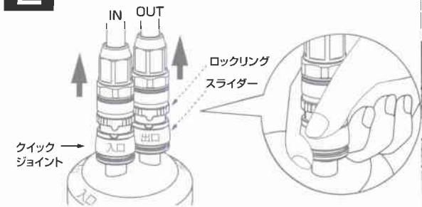
浄水器カートリッジと配管(2本とも)をつないでいるクイックジョイントを、引き上げてください。
