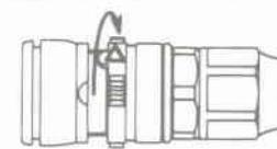
②ロックリングを矢印△の方向にカチッと音がするまで(約90°)回すとロック状態になります。
