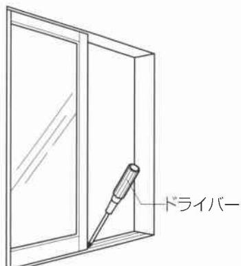
③緩めたねじを指先でつまみ、レールを上に引張ります。内観右側には、外部側レールを外した後、アタッチメントを外してください。
