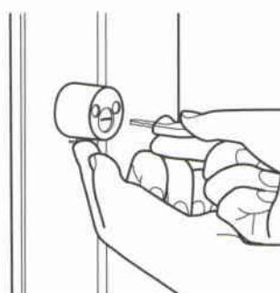
シリンドラー下部のボタンを押すだけでサムターンを取り外せます。
