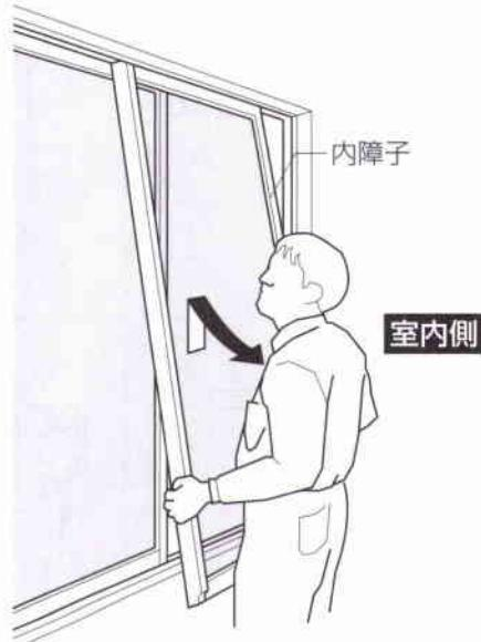
③外障子下框中央の外れ止めを、下枠中央の切欠きに合わせます。
