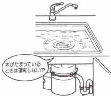
本体やシンクが大きく振動し、本体が落ちてけがをしたり流し台内部の破損・水漏れの原因になることがあります。
