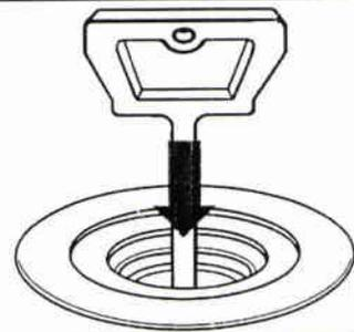
2. 『噛みこみ解除工具』を軽く左右方向いずれかに回転させると、突起部分が本体内部のスイングハンマーに引っかかります。
