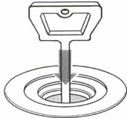
2. 『噛みこみ解除工具』を軽く左右方向いずれかに回転させると、先端部がスイングハンマーに引っかかります。
