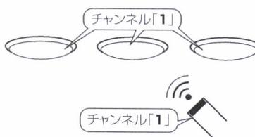
**ご注意** 複数の器具を異なるチャンネルに設定したい場合は、設定したい器具以外はスイッチをOFFにしてください。スイッチがONのままだと、設定したい器具以外のチャンネルも変更されます。
