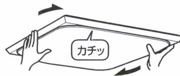
② 両手でグローブをしっかり持って、3カ所のグローブ取付具にカチッと音がして止まるまで時計回りにまわしてください。
