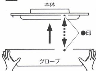
① 本体とグローブのそれぞれの●印(位置合わせマーク)の位置を合わせて、グローブを水平に押し上げてください。
