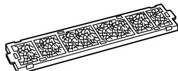
①フィルター枠からフィルターを外さずにつけ置き洗いをします。
