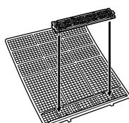
②防カビエアフィルターの爪部を室内機に確実にはめ、取付けます。
